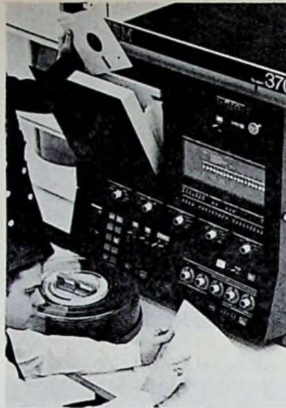
Het 'intelligente' communicatiestation IBM 3735 kan gegevens gelijktijdig op papier en magneetschijf vastleggen.
